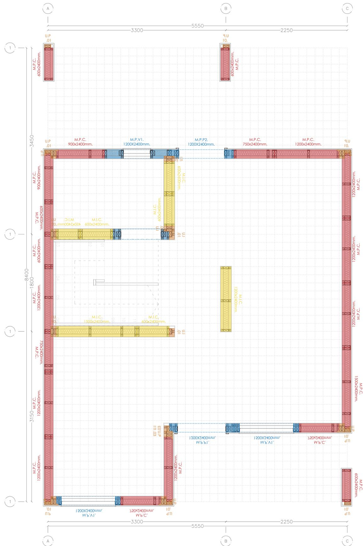
Planta primer nivel componentes de muros | "Vivienda d.s 49 tipología Aislada"
